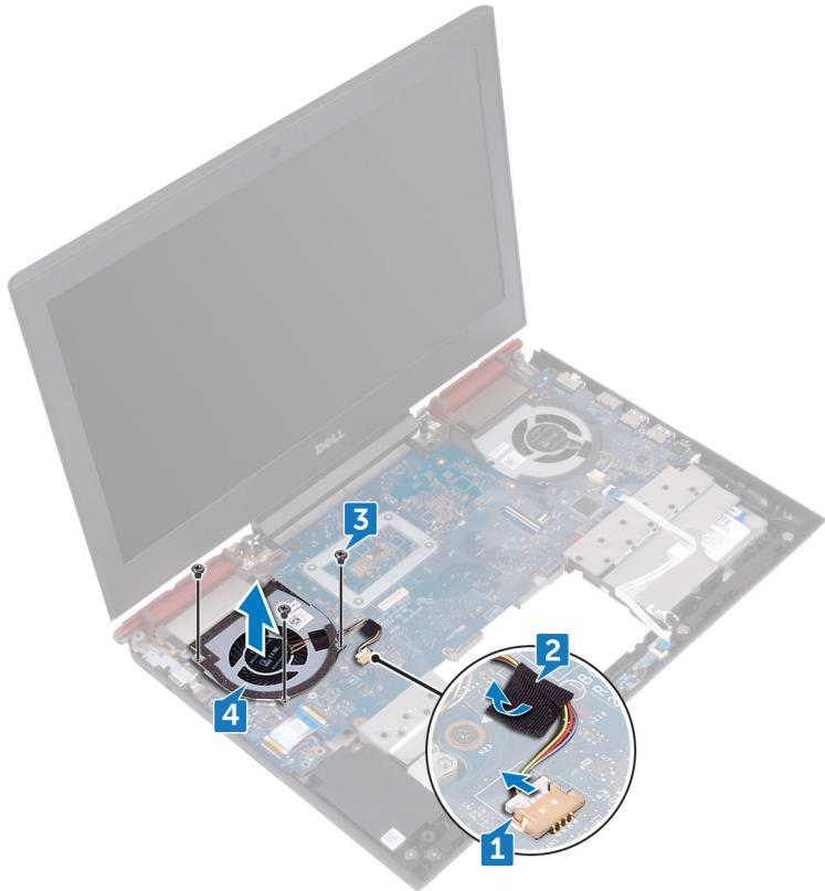
**5** 断开右侧风扇电缆与系统板的连接。
