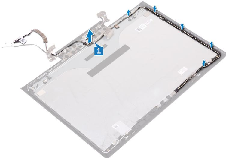
**2** 执行以上操作后，还剩下显示屏后护盖和天线部件。
