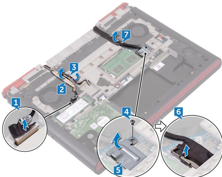
8 拧下将显示屏部件固定至计算机基座的两颗螺钉 (M2x3)。
