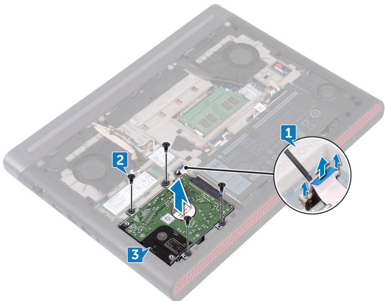
**4** 断开插入器与硬盘驱动器部件的连接。
